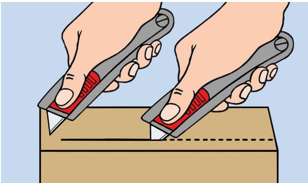
Klingenschieber zum Ausfahren der Klinge betätigen. Klingenspitze in das Schneidmaterial einführen und entlang der Schnittlinie schneiden.
