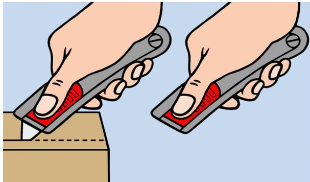
Nach dem Herausziehen der Klinge aus dem Schneidmaterial zieht sie sich vollautomatisch in das Gehäuse des Messers zurück, selbst wenn der Daumen auf dem Klingenschieber bleibt.
