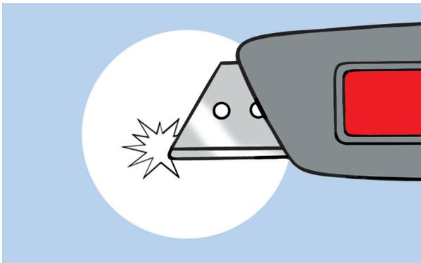
Nur Kartonnenmesser mit scharfer, unbeschädigter und gegebenenfalls abgerundeter Klinge verwenden.
