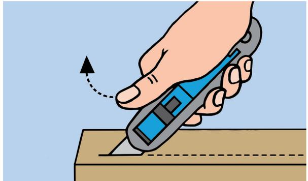
Nach dem Einstechen in das Schneidmaterial den Daumen vom Klingenschieber nehmen. Bleibt der Daumen auf dem Schieber, wird die Sicherheitsfunktion blockiert; die Klinge wird beim Lösen aus der Verpackung nicht eingezogen.
