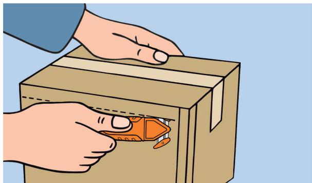
Messernase in das Schneidmaterial einführen und schräg (45°) entlang der Schnittlinie schneiden; dabei die Kartontage so festhalten, dass sie nicht kippen oder verrutschen kann.
